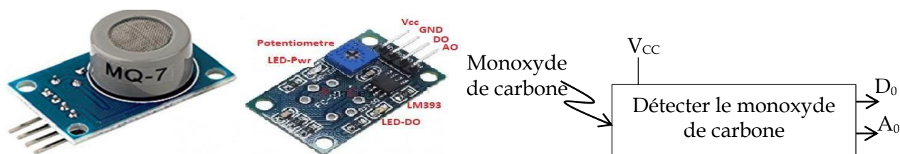
Figure 4 : Le détecteur du monoxyde de carbone MQ-7
